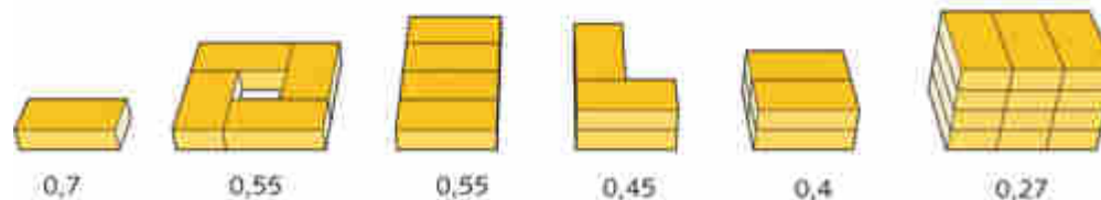
A/V-Verhältnis bei der Zusammensetzung eines Körpers von 10\text{m} \times 20\text{m} \times 5\text{m}
